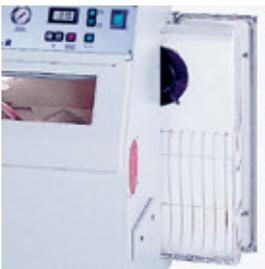
1. Der großflächige Feinstfilter, der dem Filterbeutel nachgeschaltet ist, fängt selbst noch Mikro-Feinstäube von  $0,5 \mu$  Korngröße zu 99,98 % auf. Der von der Berufsgenossenschaft geforderte Durchlasswert von kleiner als 0,1 % wird somit wesentlich unterschritten.
