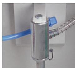
Der enorm leistungsstarke Injektor mit Borkarbid-Strahldüse wird bei Handstrahlbetrieb einfach aus der Halterung herausgenommen und von Hand geführt, wobei der Sandstrahl über das Fußventil
