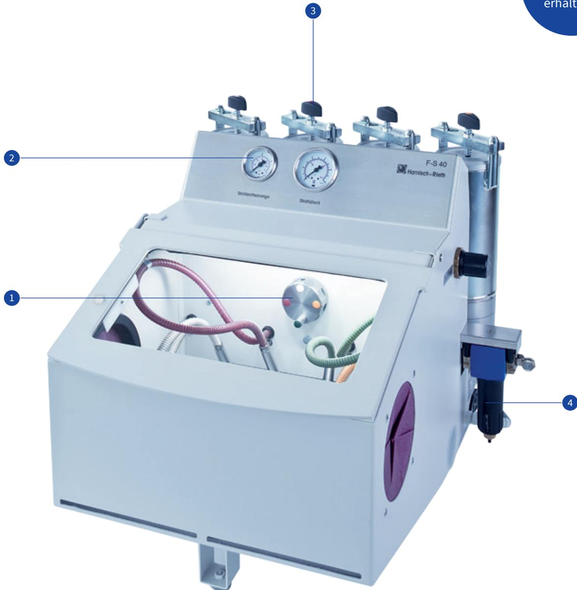
**1.** Einfache Auswahl des gewünschten Strahlmittelbehälters durch einen Wahlschalter im ideal ausgeleuchteten Innenraum.
