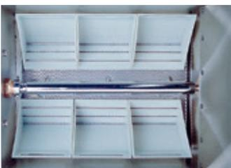
**1.** Das Sprührohr ist einfach herauszunehmen, was den Zugang zur Wanne beim Reinigen immens erleichtert. Die eingesetzte Filtermatte ist leicht zu auszuwechseln, filtert Wachsreste heraus und hält dadurch das Wasser stets sauber.
