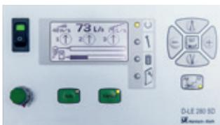
Die Höhe des Luftstromvolumens sowie Informationen über den Verschmutzungsgrad der Filtermedien sind im Display ablesbar.
